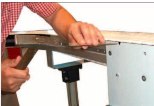
An der Montageöffnung den Kettenbolzen montieren und damit die Kette schließen.
