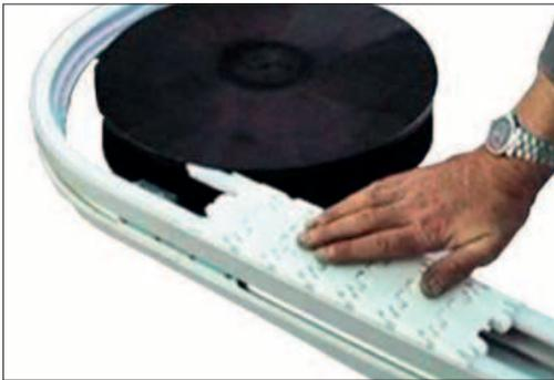
Mit einem kurzen Kettenstück den Lauf überprüfen.
