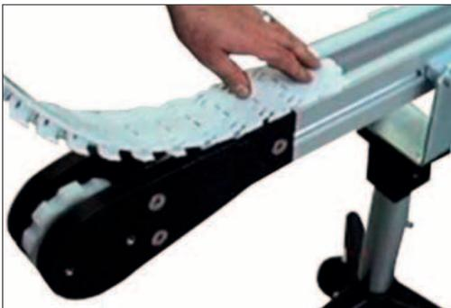
Förderkette in Laufrichtung in die Umlenkung einführen und nachschieben-/ziehen bis die Kette komplett durch den Förderer durchgezogen ist.
