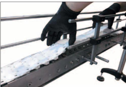
Förderkette in Laufrichtung in die Umlenkung einführen und nachschieben-/ziehen bis die Kette kompl. durch den Förderer durchgezogen ist.
