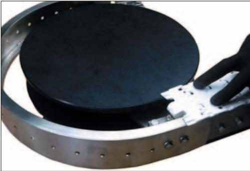
Mit einem kurzen Kettenstück den Lauf überprüfen.
